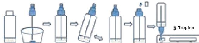
3. Nehmen Sie die Testkassette aus dem Beutel, legen Sie sie auf einen Tisch und schneiden Sie den vorstehenden Teil vom Deckel des Probenröhrchens ab. Geben Sie dann 3 Tropfen der Probe in die Probenvertiefung.
